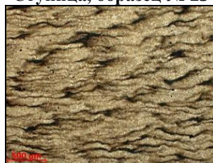
Рисунок 4 – «Следы» бывшей дендритной структуры в микроструктуре образцов стали марки 2, × 50
