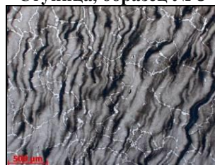
Рисунок 3 – «Следы» бывшей дендритной структуры в микроструктуре образцов стали марки ER 7, \times 50
