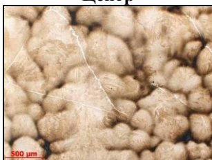
Рисунок 4 – «Следы» бывшей дендритной структуры в микроструктуре образцов стали марки 2, × 50
