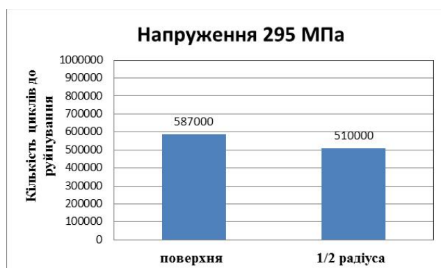
Рис. 3. Результати випробувань зразків при напруженні 295 МПа
