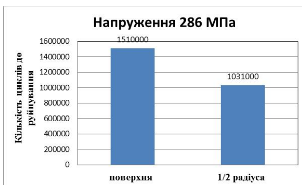
Рис. 2. Результати випробувань зразків при напруженні 286 МПа
