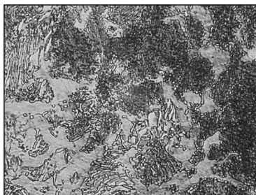
Рисунок 5.48 – Мікроструктура дослідної сталі №20 (2+ Al-Ti-N) близько поверхні злитка
