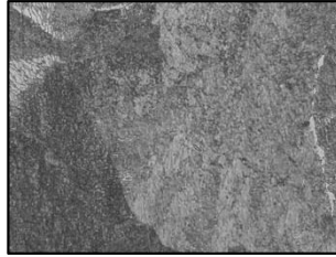
Рисунок 3.6 - Мікроструктура дослідної сталі №2 (клас «D») після гарячої пластичної деформації: а, б – \times 100 ; в, г – \times 800
