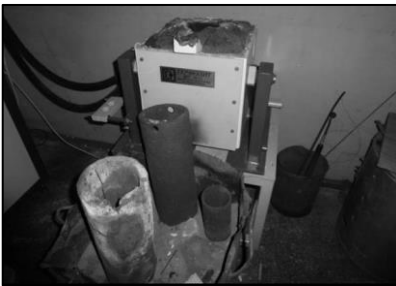
Рисунок 2.5 - Загальний вигляд плавильного модуля и графітових тиглів для розливки дослідної сталі
