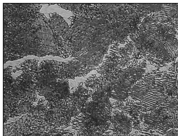
Рисунок 5.50 – Мікроструктура дослідної сталі № 20 (2+ Al-Ti-N) близько центру злитка
