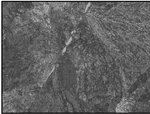
Рисунок 3.7 - Мікроструктура дослідної сталі №3 (клас «D») після гарячої пластичної деформації: а, б – \times 100 ; в, г – \times 800
