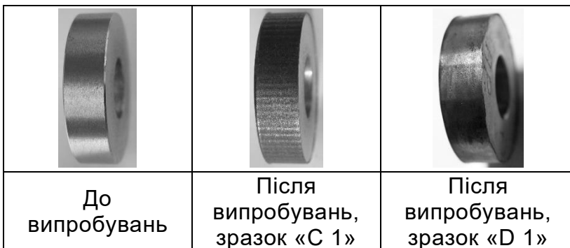
Рисунок 3.28 - Вид поверхні кочення зразків до і після випробувань.
