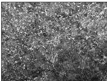
Рисунок 5.48 – Мікроструктура дослідної сталі №20 (2+ Al-Ti-N) близько поверхні злитка
