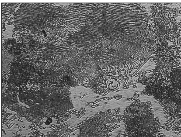
Рисунок 5.49 – Мікроструктура дослідної сталі №20 (2+ Al-Ti-N) близько \frac{1}{2} радіусу злитка
