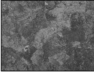
Рисунок 3.6 - Мікроструктура дослідної сталі №2 (клас «D») після гарячої пластичної деформації: а, б – \times 100 ; в, г – \times 800
