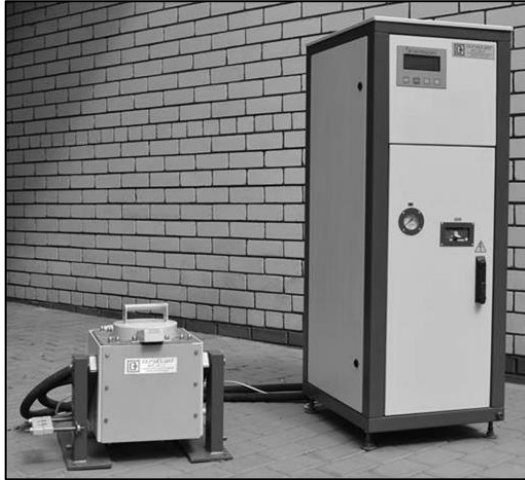
Рисунок 2.1 - Загальний вигляд експериментального комплексу, що включає в себе індукційну плавильну піч ІТПЕ-0,01 і генератор ВТГ-20-22
