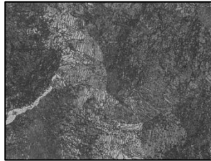
Рисунок 3.7 - Мікроструктура дослідної сталі №3 (клас «D») після гарячої пластичної деформації: а, б – \times 100 ; в, г – \times 800
