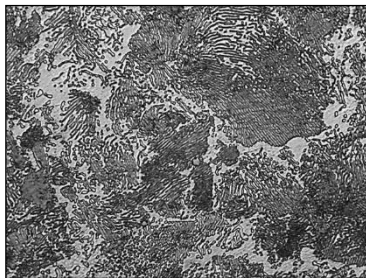
Рисунок 5.46 – Мікроструктура дослідної сталі № 19 (K+ Al-Ti-N) близько \frac{1}{2} радіусу злитка
