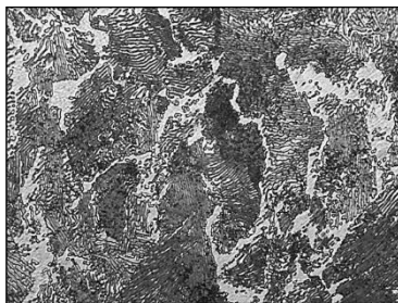
Рисунок 5.47 – Мікроструктура дослідної сталі № 19 (K+ Al-Ti-N) близько центру злитка
