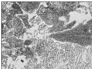
Рисунок 5.51 – Мікроструктура дослідної сталі № 17 (К) в литому стані
