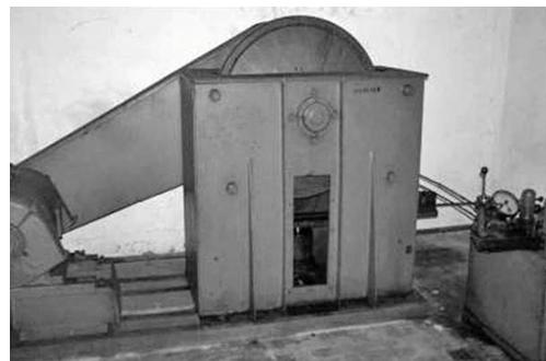
**Рис. 55.** Стенд для моделювання гальмування в зоні контакту колесо—рейка
