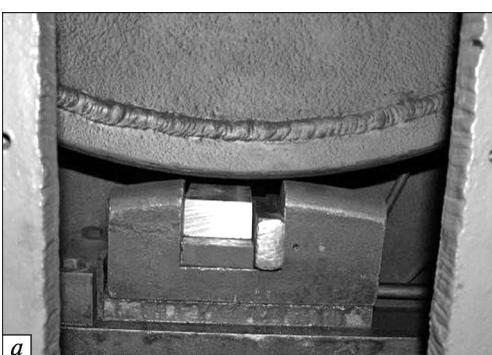
**Рис. 56.** Зразок для визначення чутливості сталі до теплового впливу: *а* — у процесі гальмування під час випробувань; *б* — після випробувань
