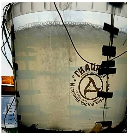
Рисунок 4.12 - Фото продувки крізь донний блок при витраті продувного газу 0,171 \text{ м}^3/\text{т}\cdot\text{год} [128, 129]
