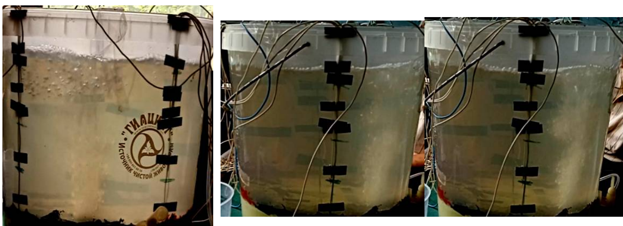
Рисунок 4.14 - Фото продувки крізь донний блок при витраті продувного газу 0,684 \text{ м}^3/\text{т}\cdot\text{год} [128, 129]
