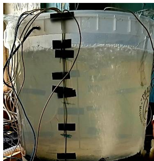
Рисунок 4.12 - Фото продувки крізь донний блок при витраті продувного газу 0,171 \text{ м}^3/\text{т}\cdot\text{год} [128, 129]
